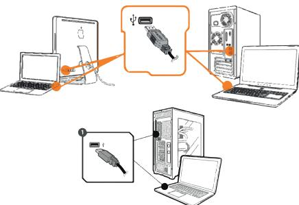
Passaggio 1: collegare il dispositivo Lexip B10 a una porta USB 2.0 / 3.0 sul computer.
