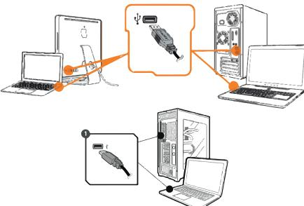
Paso 1: conecte su dispositivo Lexip B10 a un puerto USB 2.0 / 3.0 en su computadora.
