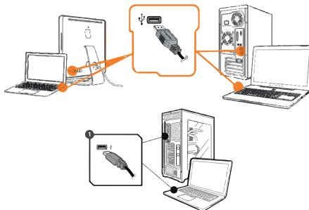
Schritt 1: Verbinden Sie Ihr Lexip B10-Gerät mit einem USB 2.0 / 3.0-Anschluss an Ihrem Computer.
